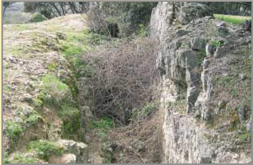
Labores en superficie de la mina "La Chaparra", que también explotó un filón de cuarzo con Pb-Zn y fluorita como ganga. Foto: R. Jiménez, 2004.
