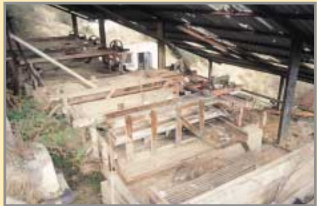
Las instalaciones se conservan en muy buen estado, como estas mesas de sacudidas para concentración de estaño. Foto: L. Jordá, 2003.
