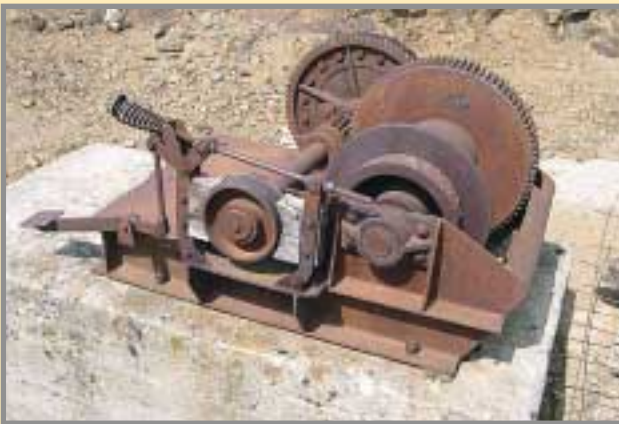
Cabestrante de servicio al pozo, entre otros elementos que aún se conservan de los trabajos del s. XX. Mina "Mónica" de Bustarviejo. Foto: R. Jiménez, 2004.
