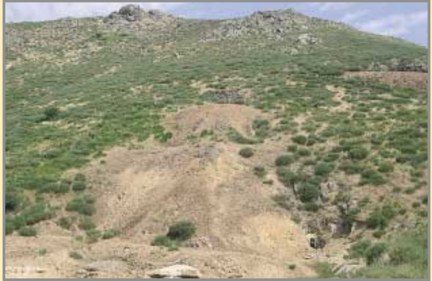
En la mina "Mónica" el mineral se presenta en bolsadas y pequeños filones de cuarzo. Esta mineralización se dispone en una zona de brechificación de los ortogneises bandeados encajantes. Vista de escombreras, con acceso al socavón de la galería de arrastre (abajo a la derecha). Foto: R. Jiménez, 2004.
