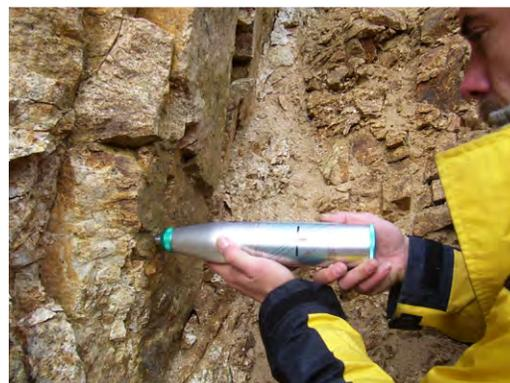
Figura 27: Medidas esclerométricas sobre juntas en el emboquille de una mina.
