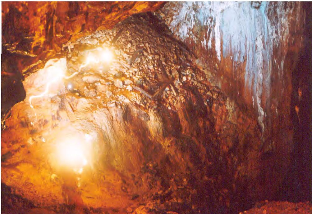
Figura 200: Gran sala o "Plaza de Toros". Pozo Maestro de la mina de Plata de Bustarviejo. A cavidad no tiene sostenimiento artificial alguno.
