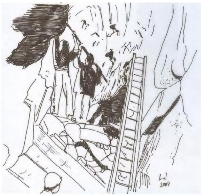
Figura 130: Saneo de un anchurón. Dibujo propio.
