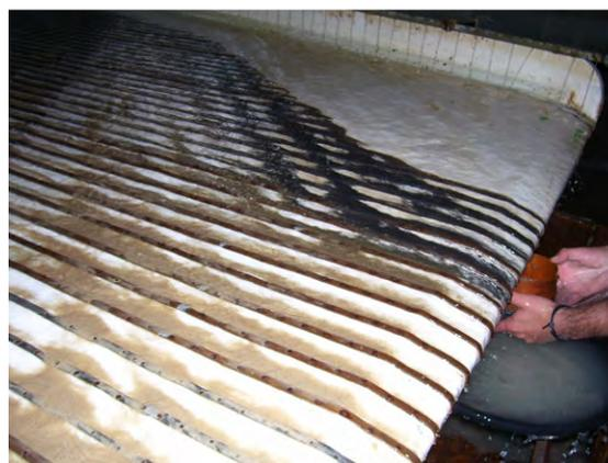
Figura 127: Sobre estas líneas diversas imágenes de la campaña de prospección llevada a cabo en Mina Maribel en 2006. Detalle de la concentración en mesas de sacudidas y el pre-cribado mediante zaranda.
