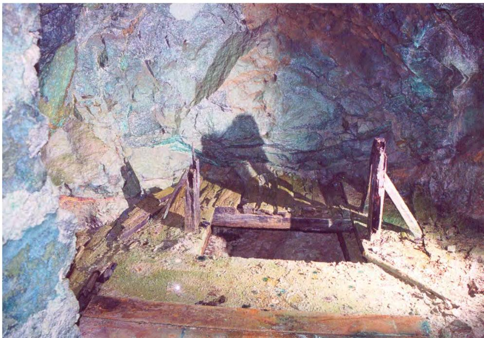
Figura 117: Torno manual en interior de la mina de cobre de Colmenarejo (2003).
