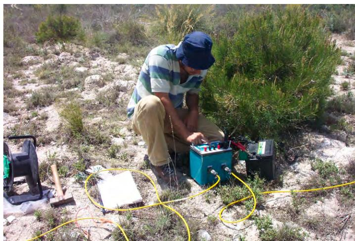
Figura 19: Imagen de equipo de tomografía eléctrica empleado.
